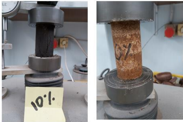
الشكل (3-11) عينات الضغط الحر بعد الاختبار
