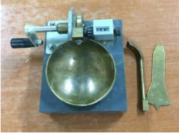
الشكل (3-3) جهاز غزاكراندي
