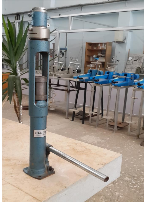
الشكل (8-3) الكريكو الخاص لنزع عينة الضغط الحر
