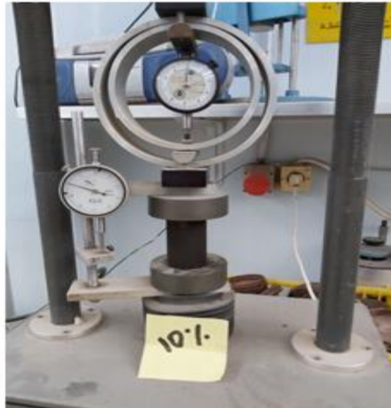
الشكل (9-3) جهاز الضغط الحر
